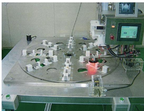
試作したラッキョウ自動切断装置
